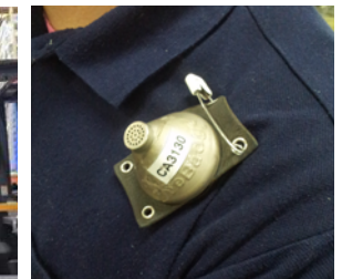
작업 환경(소음) 측정
